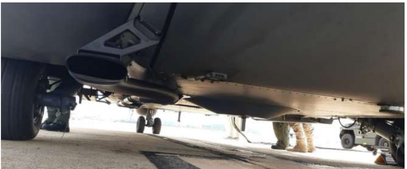
Figura 15. Detalle de la instalación real de la antena en el NH90
