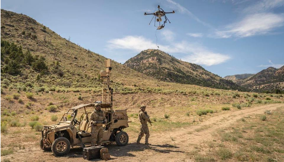
Figura 27 Dron Skyraider de Aeryon Labs, de tipo cautivo o tethered . Fuente: [70].
