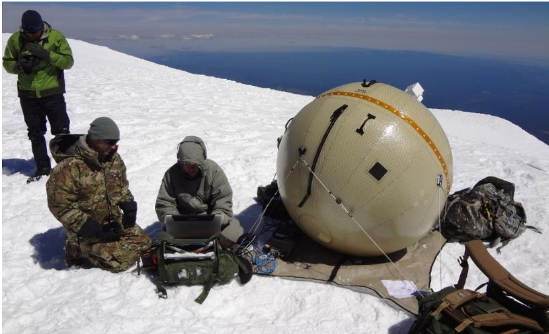
Figura 31 Sistema ultrapotátil de comunicaciones por satélite de GATR se utiliza durante un ejercicio de las fuerzas de operaciones especiales en Mt Adams, Washington. Fuente: [82].
