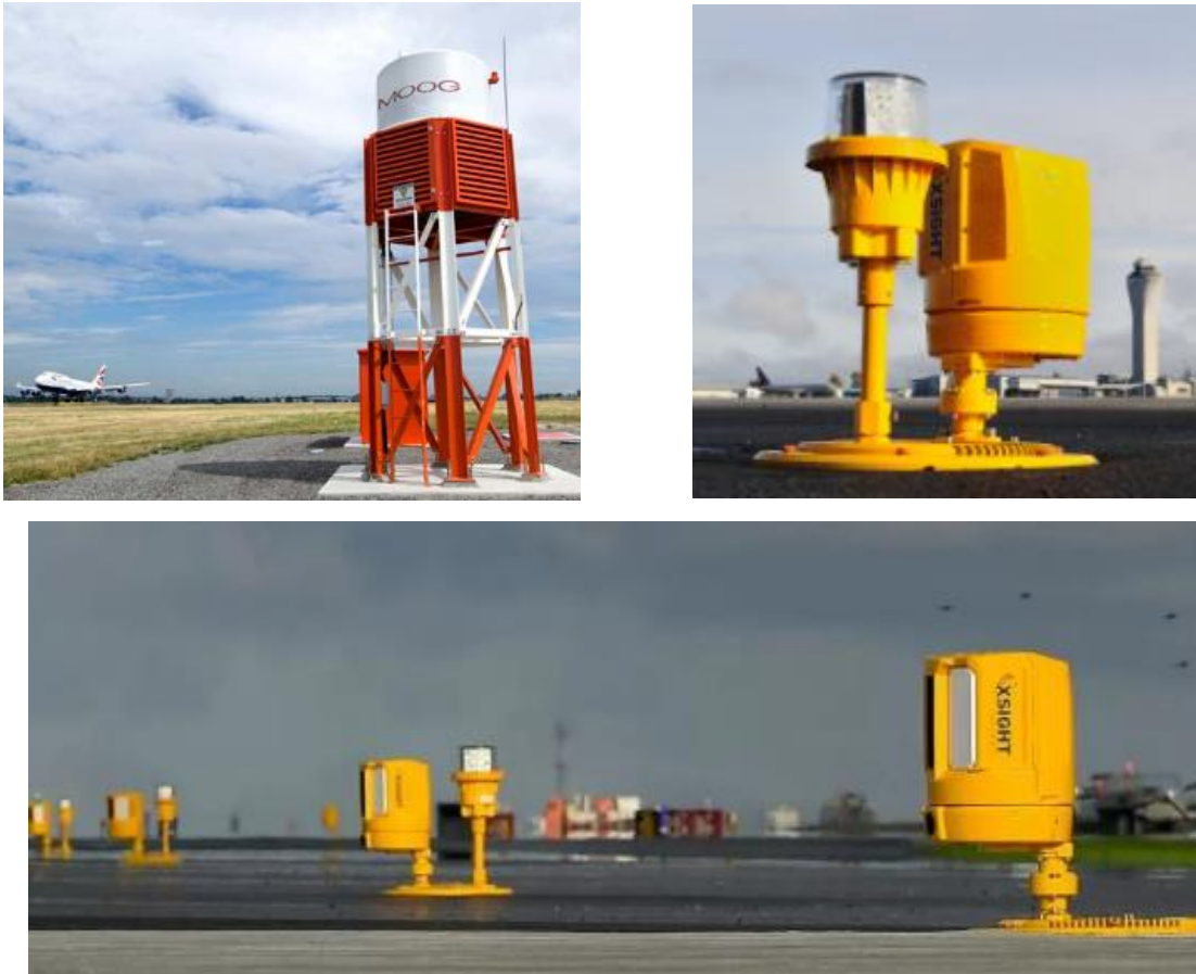
Figura 19 Radares contra FOD fijos con aplicación al mercado civil. Tarsier Automatic Runway FOD Detection System de MOOG (fotografía superior izquierda) y Surface Detection Unit (SDU) de la plataforma RunWize de Xsight System (fotografías restantes). Fuentes: Sitios web de los desarrolladores de ambas soluciones [50], [52].
