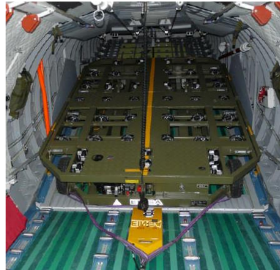
Figura 7 Transporte de quads en el interior de un T.21 (C295), izquierda, y sistema autopropulsado de transferencia de pallets, derecha. Fuente: [26].
