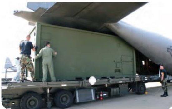
Figura 16 Carga de un contenedor ISO-20 en una aeronave C-130 (izquierda) e izado de éste mediante una carretilla elevadora (derecha). Se hace notar que, aunque sus
