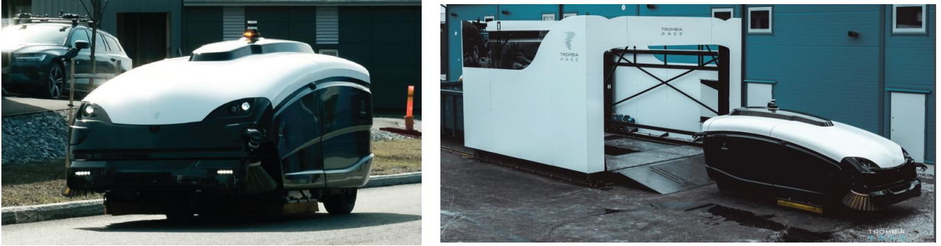
Figura 22 Trombia Free en servicio (izquierda) y saliendo de su estación de servicio tipo dock-station (derecha), que hace las veces de centro de carga, mantenimiento, limpieza y vaciado de la materia recolectada. Fuente: [59].
