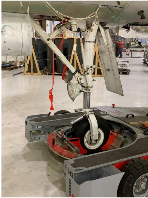
Figura 29 TowFLEXX 5.4 (TF-5) amarrando la rueda del tren de aterrizaje delantero de un F-15 en Robins AFB (izquierda) y WIDE 14 de Mototok operando con un C-130 (derecha). Fuente: [74] y [75].
