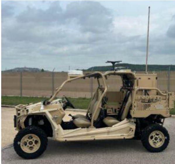
Figura 32 Paquete de sistemas Tactical Integrated Communications Suite (TICS) de 4K Solutions instalado en un Polaris Defense MRZR UTV. Fuente: [83].
