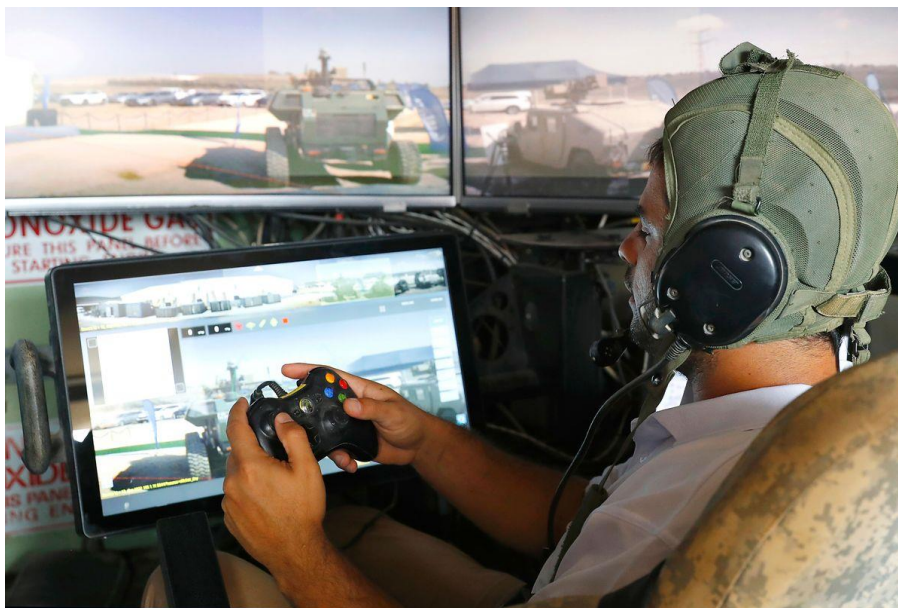
Figura 39 Controlador XBOX empleado para controlar un UGV. La línea que separa la tecnología civil de la militar es cada vez más difusa y elementos COTS facilitan la integración y la curva de aprendizaje. Fuente: [92].
