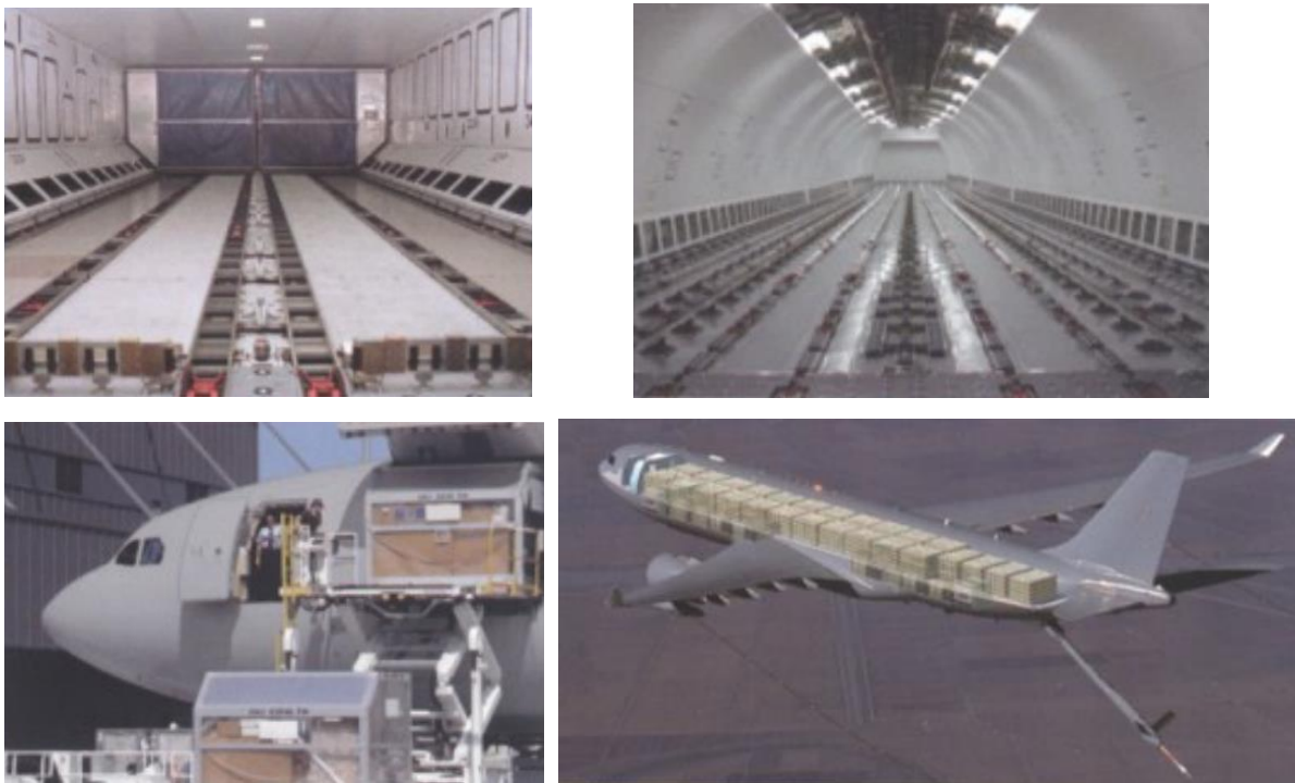
Figura 12 De izquierda a derecha y de arriba abajo, compartimentos de carga en bodega, sistema de desplazamiento de carga, puerta lateral de carga y esquema de la configuración de carguero puro de un T.24/TK.24 (A300 MRTT). Fuente: [29].
