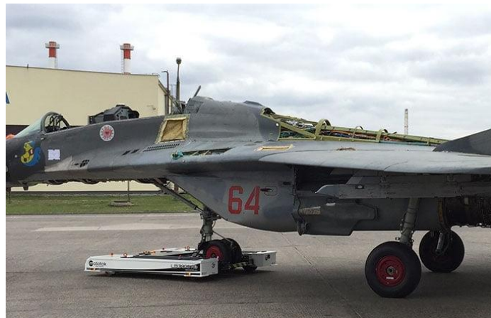
Figura 34 Tractor eléctrico operado remotamente LB 3900 NG de Mototok, identificado como solución compatible a las capacidades y necesidades del Ejército del Aire y del Espacio, y dispositivo empleado para su control. Nótese su aplicación al ámbito militar. Fuente: [46].
