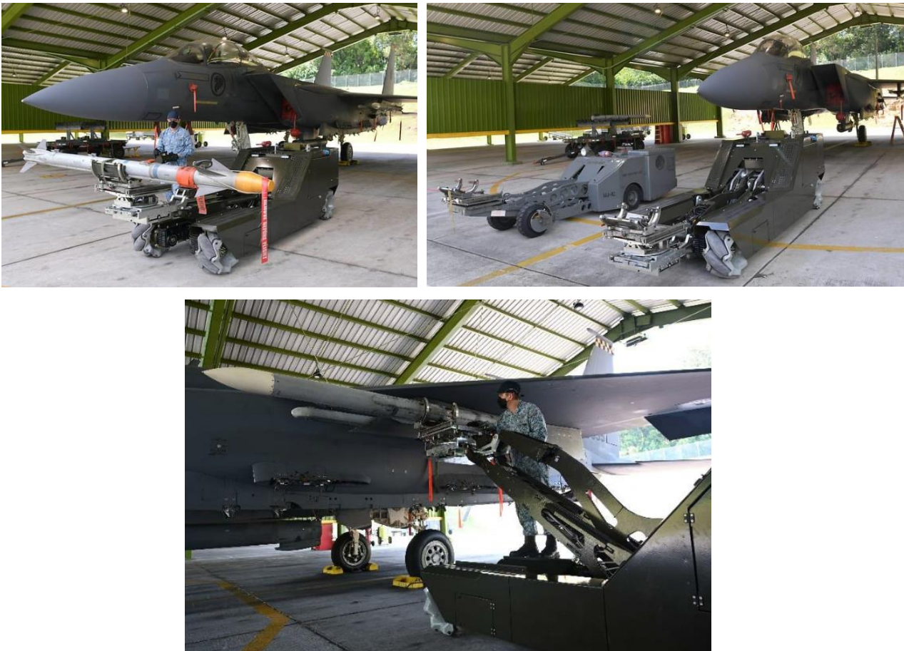
Figura 24 Sistema de rearmamiento desarrollado en el contexto de la RSAF Smart Airbase , la Fuerza Aérea de la República de Singapur. Nótese el sistema de ruedas
