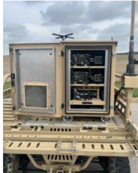
Figura 32 Paquete de sistemas Tactical Integrated Communications Suite (TICS) de 4K Solutions instalado en un Polaris Defense MRZR UTV. Fuente: [83].
