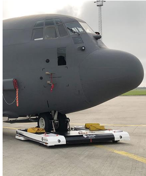
Figura 29 TowFLEXX 5.4 (TF-5) amarrando la rueda del tren de aterrizaje delantero de un F-15 en Robins AFB (izquierda) y WIDE 14 de Mototok operando con un C-130 (derecha). Fuente: [74] y [75].
